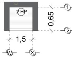
DUCTO TOTALMENTE RECTO DE Ø 3" PARA CANALIZACIÓN DE SISTEMA HIDRÁULICO.
