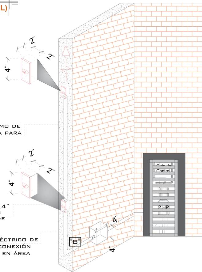
POLIDUCTO MÍNIMO DE Ø 1" EMPOTRADA EN MURO PARA INSTALACIÓN DE BOTONERAS
