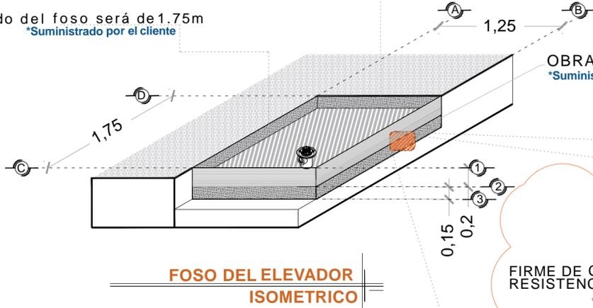
OBRA CIVIL PARA EL ANCLAJE DEL EQUIPO
