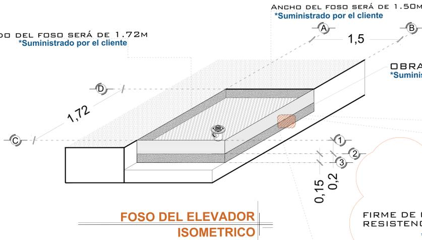
OBRA CIVIL PARA EL ANCLAJE DEL EQUIPO
