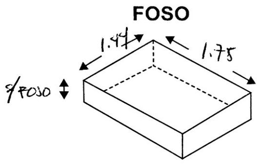
\* DEJAR 2.50 DE PROFUNDIDAD PARA COLOCAR ACABADO DECK (2.5cm) MAS (2.5cm) SEGUN MEDIDOR
