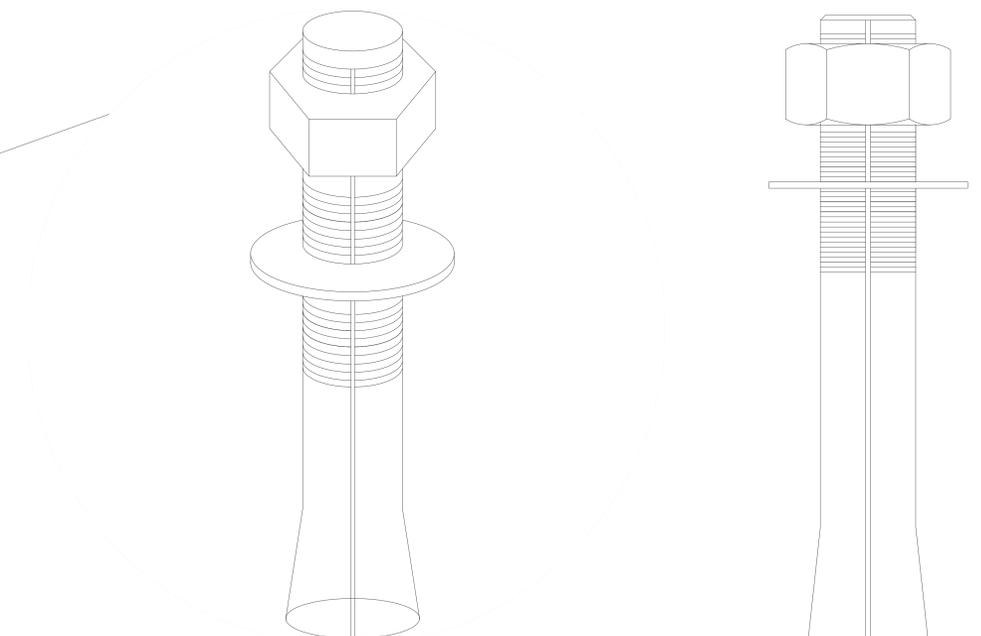
PARA LA CORRECTA INSTALACIÓN DEL EQUIPO ES NECESARIO COLOCAR TAQUETES EXPANSIVOS DE  $\frac{3}{4}$ " X  $4\frac{3}{4}$ " PARA EL ANCLAJE DE COLUMNAS CON EL FIRME. POR LO QUE SE REQUIERE UNA BASE DE CONCRETO ARMADA CON MALLA ELECTROSOLDADA 6.6.10.10 DONDE SE DEBERÁ DE UTILIZAR UN CONCRETO CON UNA RESISTENCIA F´C 250KG/CM2 Y UN ESPESOR DE 0.15M.
