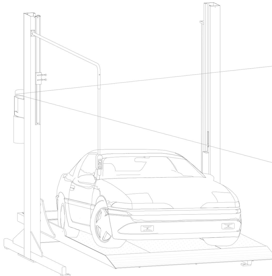
LA UNIDAD HIDRÁULICA SE UBICARÁ SOBRE LA COLUMNA DE LADO IZQUIERDO DE LA MISMA, POR LO QUE SERÁ NECESARIA LA COLOCACIÓN POR PARTE DEL CLIENTE DE UNA CAJA DE REGISTRO.
