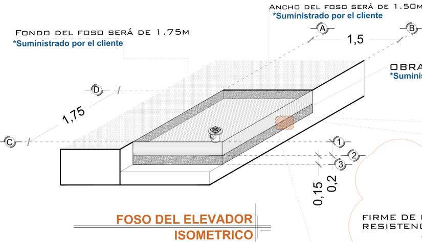
OBRA CIVIL PARA EL ANCLAJE DEL EQUIPO
