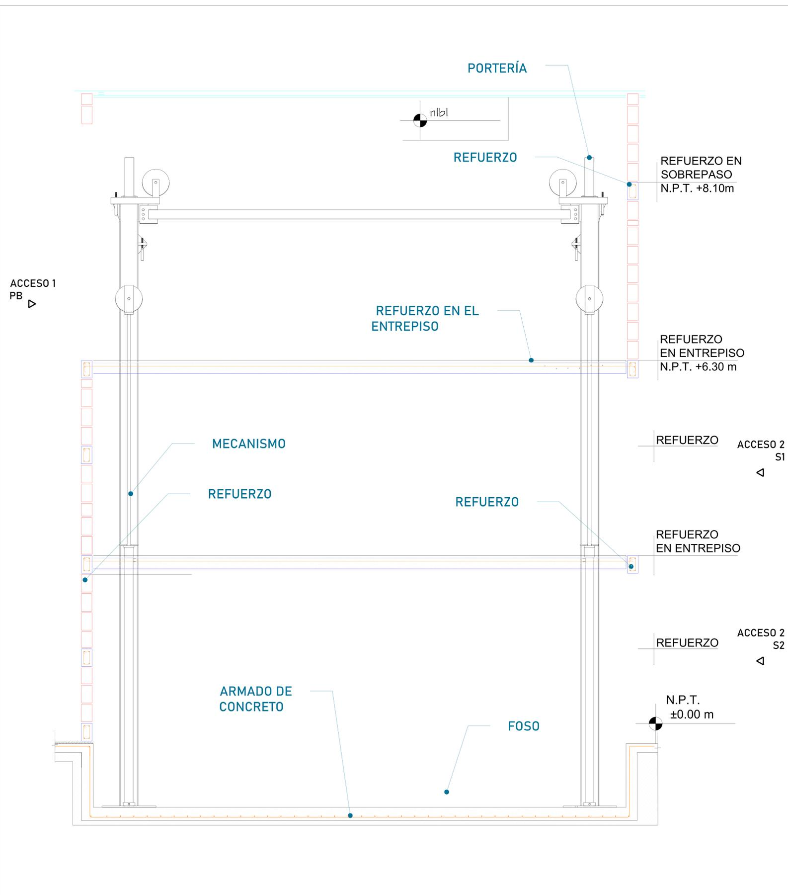
Para la estabilidad del equipo Tecnorampa debera ser anclado aun cierto numero de refuerzos estos serán de acuerdo al recorrido del equipo y a los distintos niveles que se tengan. Para anclar se solicita una cadena de concreto ( $f'c=250 \text{ kg/cm}^2$ ) o una viga de acero, ambas minimo de 15 cm. En la ultima estación nuestras columnas tienen un sobrepaso de 1.80m por lo tanto se solicita un refuerzo a esa altura.
