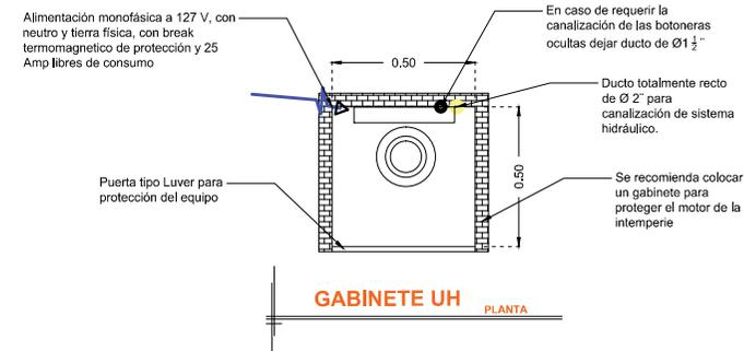
**NOTA:** Por cada nivel adicional deberá de colocar una chalupa para alojar el botón de llamado y debería de continuar la tubería hasta esta.
