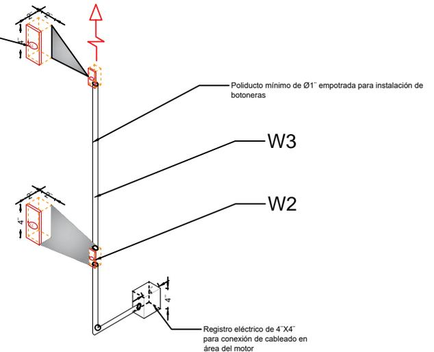
\*Tubería y registro eléctricos suministrados por el cliente, únicamente ductería sin cableado
