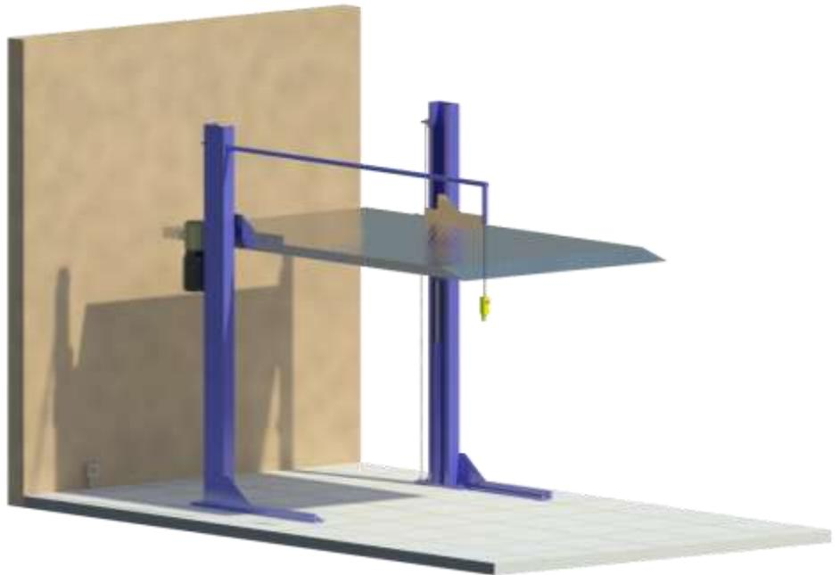
La unidad hidráulica se ubicara sobre la columna del lado izquierdo de la misma, por lo que será necesaria la colocación por parte del cliente de una caja de registro, la cual se puede colocar en forma elevada sobre el firme a unos 15 cm de separación de este y de 10 a 20 cm de separación a la placa base de la columna.
