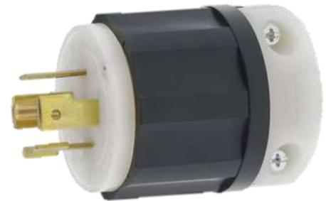
En la caja de registro eléctrico que se instale, se deberá colocar la clavija de medio giro, esto con la finalidad de realizar la conexión de la alimentación con la unidad hidráulica, y facilitar que posteriormente el usuario, en caso de emergencia, necesite deshabilitar la alimentación del equipo, únicamente tenga de desenchufar la clavija como lo haría con cualquier otro equipo eléctrico.
