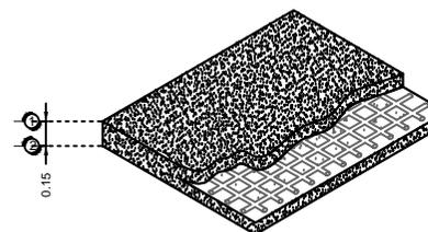
**ARMADO DE FIRME PARA UNIDAD HIDRAULICA**
