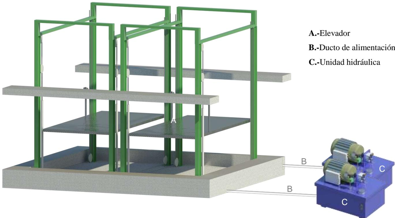
La unidad hidráulica y control eléctrico deberán ser instalados fuera del foso y ubicarse en un lugar libre de polvo, líquidos e inclemencias del clima, evitando que se contamine el aceite y se pierda la garantía del equipo.
