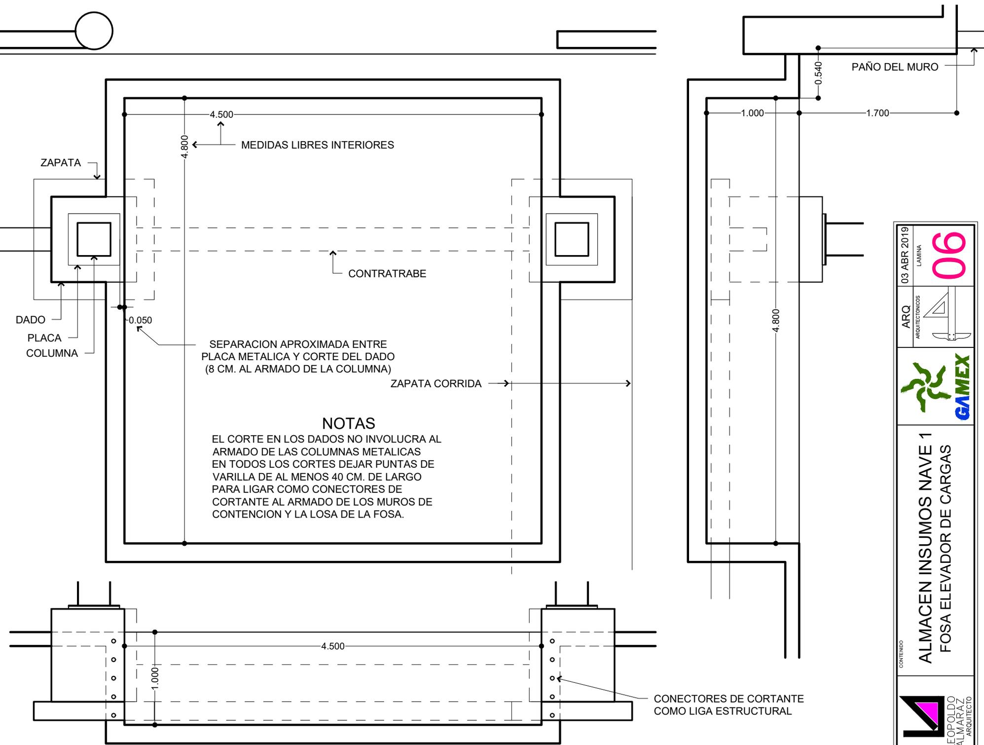
SEPARACION APROXIMADA ENTRE PLACA METALICA Y CORTE DEL DADO (8 CM. AL ARMADO DE LA COLUMNA)
