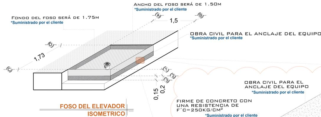
OBRA CIVIL PARA EL ANCLAJE DEL EQUIPO
