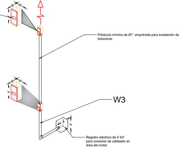
\*Tubería y registro eléctricos suministrados por el cliente, únicamente ductería sin cableado (DEJAR GUIADA CANALIZACIÓN)
