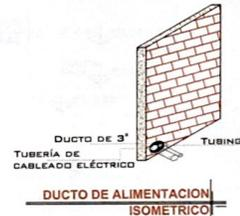
LA DISTANCIA 'B' SE CUBRIRÁ DE SER POSIBLE CON DUCTOS REALIZADOS CON TUBERÍA Y LA BALIDA EN EL FONDO SERÁ RECOMENDABLE UBICARLA DEL LADO DONDE SE ENCONTRARAN LAS COLUMNAS Y EL RESTO DE LA ESTRUCTURA DEL ELEVADOR. EN CASO DE QUE NO SE PUEDA INSTALAR ESTOS DUCTOS SE EMPLEARÁ UNA CANALIZACIÓN DIFERENTE QUE PROTEJA EL CABLEADO. EN CUALQUIERA DE LOS DOS CASOS ESTÁ SERÁ SUMINISTRADA POR PARTE DE TECNORAMPA Y LOS TRABAJOS PARA SU INSTALACIÓN LO HARÁ EL EQUIPO DE LA EMPRESA.
