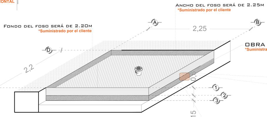
OBRA CIVIL PARA EL ANCLAJE DEL EQUIPO
