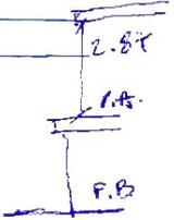
NOTA: FIRME DE CONCRETO DE 15 CM DE ESPESOR CON RESISTENCIA DE 250 KG/CM2. ARMADO CON MALLA ELECTROSOLDADA
