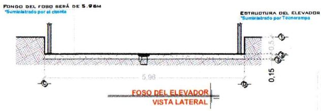
POR MOTIVO DE SEGURIDAD ANTE POSIBLES AGUMULACIONES DE AGUA, COMO INUNDACIONES O FUGAS, SE RECOMIENDA LA INSTALACIÓN UNA SALIDA DE TUBERÍA DE DRENAJE (COLADERA) PARA DESALJAR EL AGUA QUE SE PUDIERA ALMACENAR EN EL FOSO. DICHA TUBERÍA SE CONECTARÁ A LA RED DE DRENAJE O ÁREAS VERDES SEGÚN LA DECISIÓN DEL CLIENTE.
