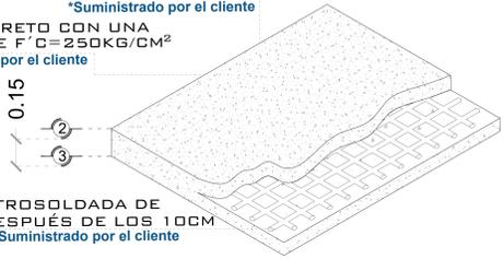
**ARMADO DE FIRME ISOMETRICO**
