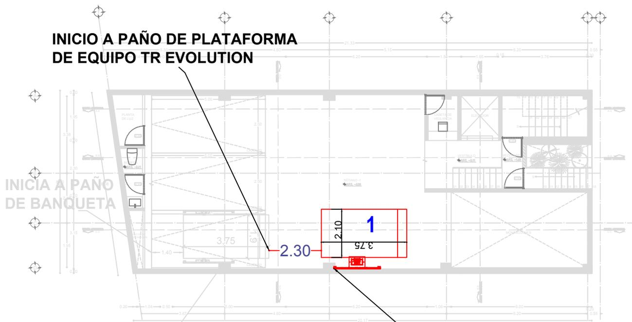
EXTENSIÓN DE EQUIPO A PAÑO DE COLUMNA ESTRUCTURAL DEL EDIFICIO
