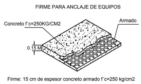
Firme: 15 cm de espesor concreto armado f'c=250 kg/cm2
