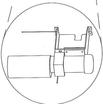
LA UNIDAD HIDRÁULICA SE UBICARA SOBRE LA COLUMNA DE LADO IZQUIERDO DE LA MISMA, POR LO QUE SERÁ NECESARIA LA COLOCACIÓN POR PARTE DEL CLIENTE DE UNA CAJA DE REGISTRO.
