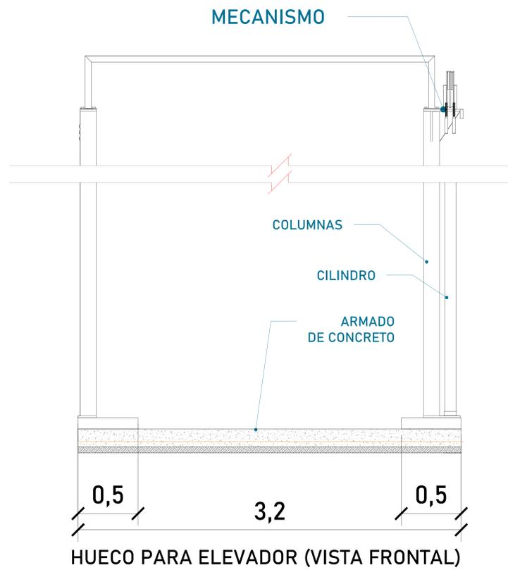
SE REQUIERE UNA ALTURA LIBRE DE 0.45 M LIBRE EN TODA EL ÁREA DE 5.95 X 3.20 M PARA LA INSTALACIÓN Y CORRECTO USO DEL EQUIPO DE TECNORAMPA Y UNA RESISTENCIA DE F'C= 250KG/CM2
