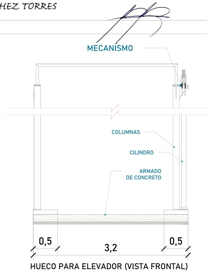
SE REQUIERE UNA ALTURA LIBRE DE 0.45 M LIBRE EN TODA EL ÁREA DE 5.95 X 3.20 M PARA LA INSTALACIÓN Y CORRECTO USO DEL EQUIPO DE TECNORAMPA Y UNA RESISTENCIA DE F'C= 250KG/CM2
