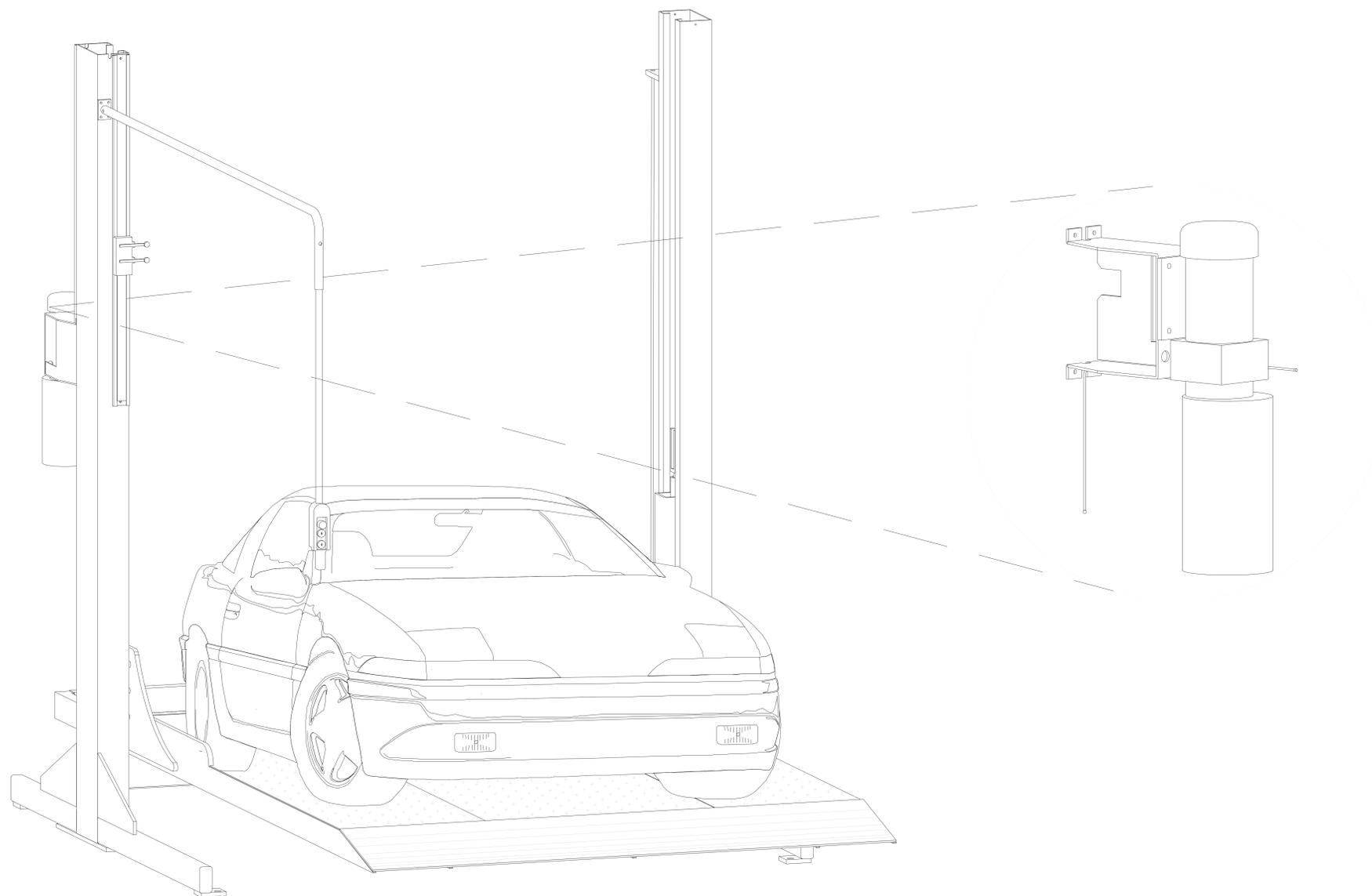
LA UNIDAD HIDRÁULICA SE UBICARA SOBRE LA COLUMNA DE LADO IZQUIERDO DE LA MISMA, POR LO QUE SERÁ NECESARIA LA COLOCACIÓN POR PARTE DEL CLIENTE DE UNA CAJA DE REGISTRO.
