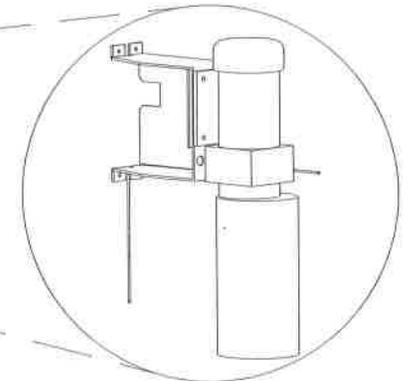
LA UNIDAD HIDRÁULICA SE UBICARÁ SOBRE LA COLUMNA DE LADO IZQUIERDO DE LA MISMA, POR LO QUE SERÁ NECESARIA LA COLOCACIÓN POR PARTE DEL CLIENTE DE UNA CAJA DE REGISTRO.
