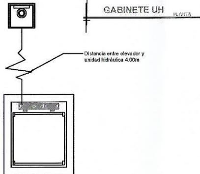
**NOTA:** Por cada nivel adicional deberá de colocar una chalupa para alojar el botón de llamado y debería de continuar la tubería hasta esta.
