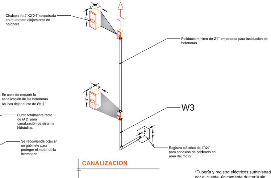
\*Tubería y registro eléctricos suministrados por el cliente, únicamente ductería sin cableado
