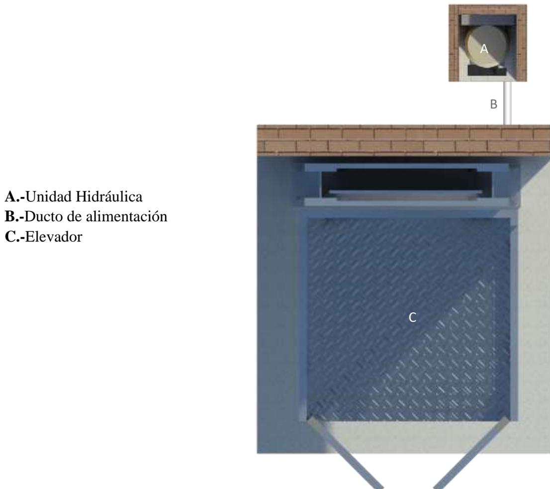
**NOTA:** La distancia B se cubrirá de ser posible con ductos realizados con tubería, y la salida en el foso será recomendable ubicarla del lado donde se encontraran las columnas y el resto de la estructura del elevador. En caso de que no se pueda instalar estos ductos se empleara una canalización diferente que proteja el cableado. En cualquiera de los dos casos esta será suministrada por parte de Tecno Rampa, y los trabajos para su instalación lo hará el equipo de la empresa.
