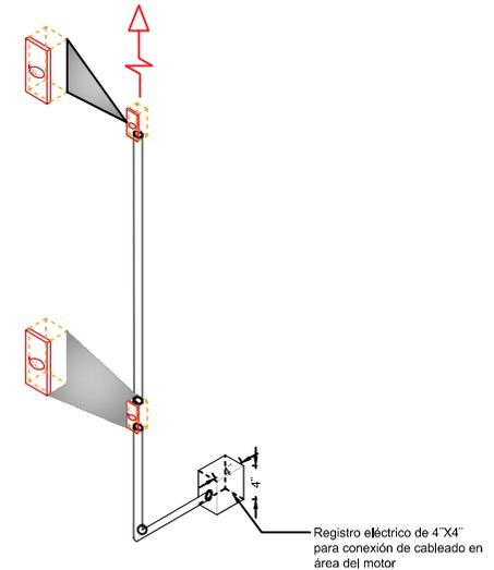
\*Tubería y registro eléctricos suministrados por el cliente, únicamente ductería sin cableado
