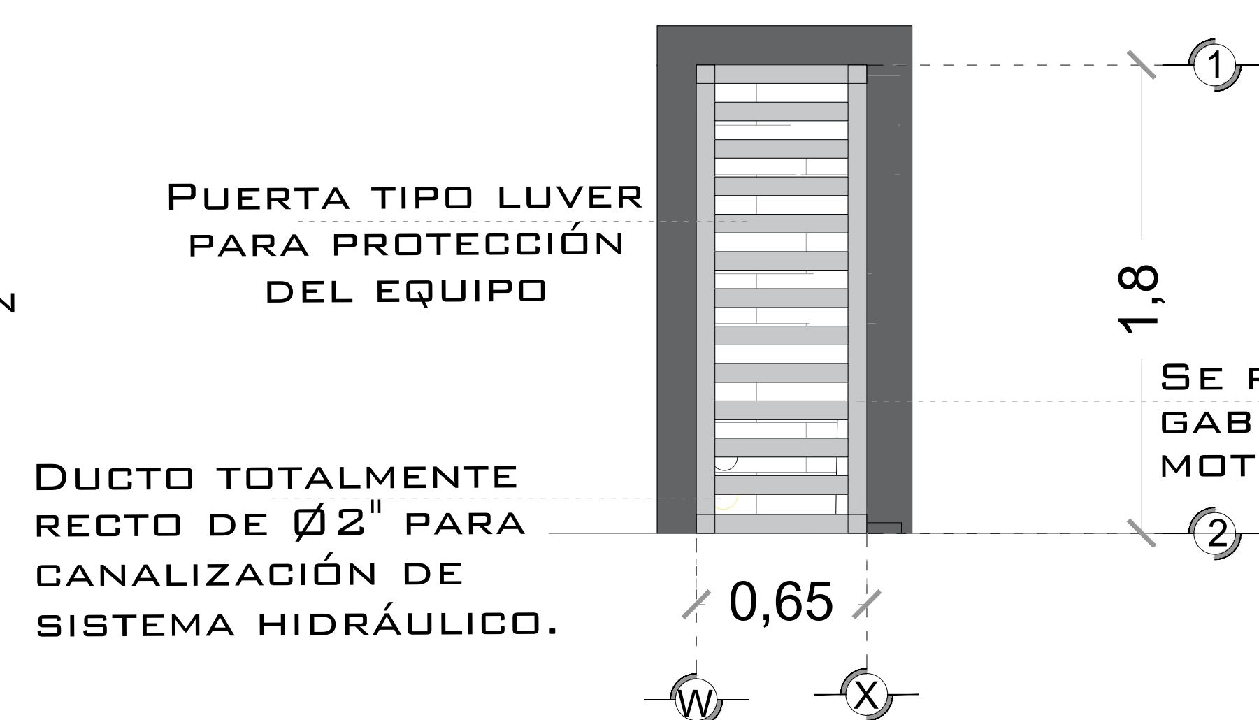
DESCRIPCION DE UNIDAD HIDRAULICA GABINETE (VISTA FRONTAL)
