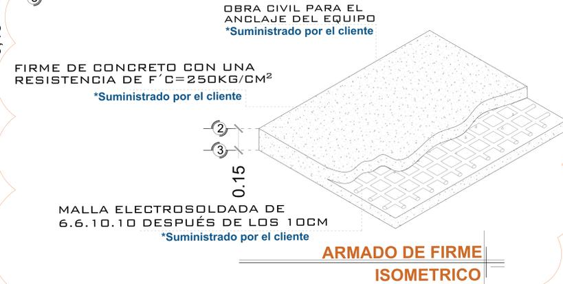
**ARMADO DE FIRME ISOMETRICO**
