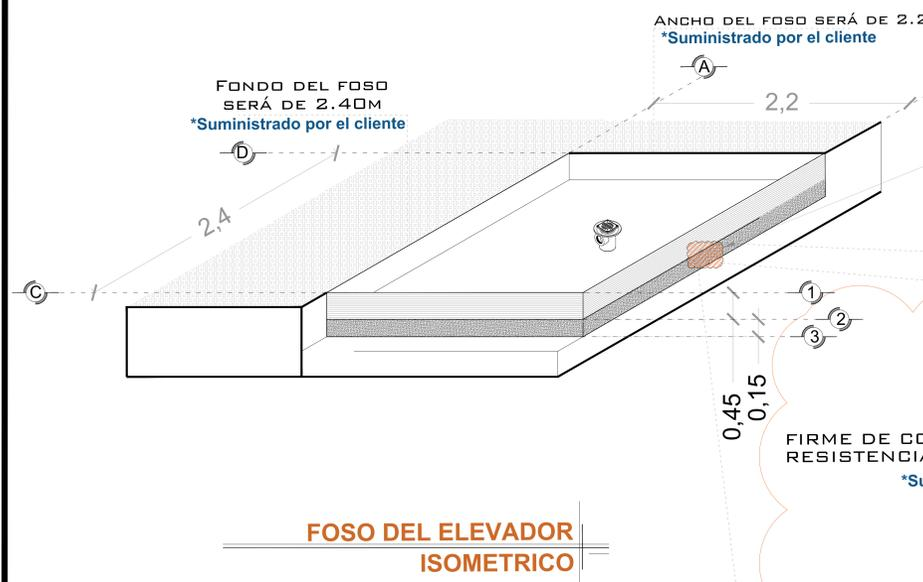
OBRA CIVIL PARA EL ANCLAJE DEL EQUIPO
