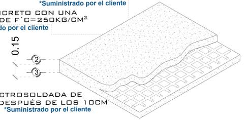
**ARMADO DE FIRME ISOMETRICO**
