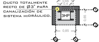
DESCRIPCIÓN DE UNIDAD HIDRÁULICA GABINETE (VISTA PLANTA)
