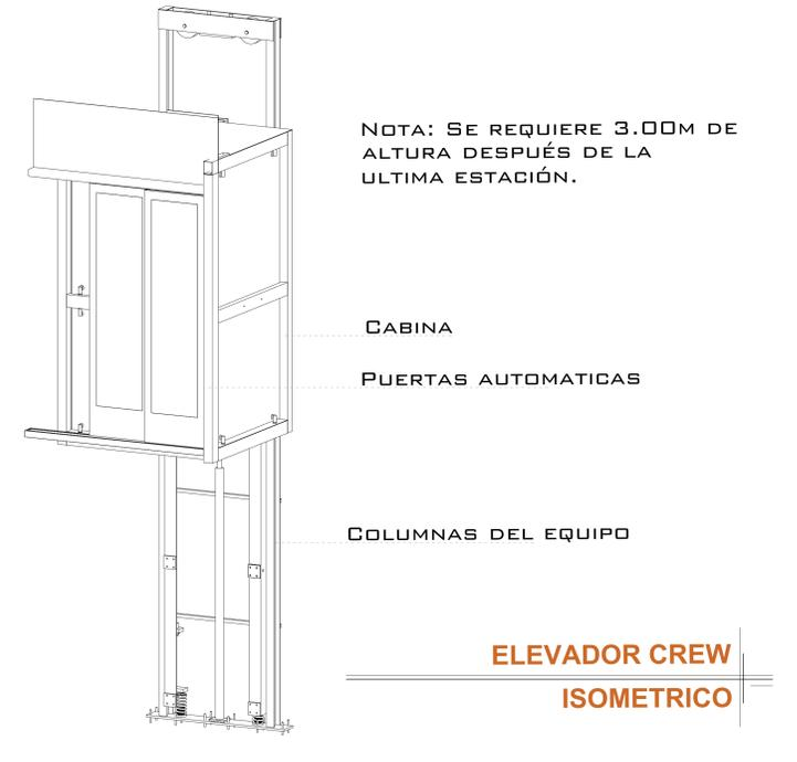
NOTA: SE REQUIERE 3.00M DE ALTURA DESPUÉS DE LA ULTIMA ESTACIÓN.
