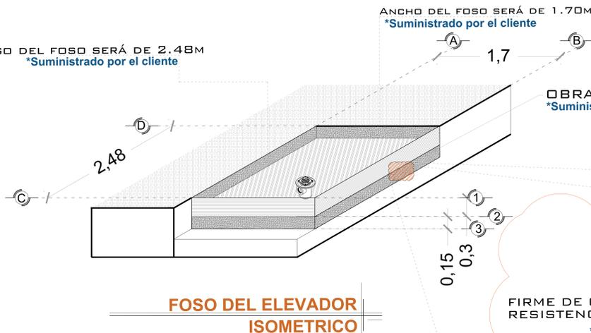
OBRA CIVIL PARA EL ANCLAJE DEL EQUIPO
