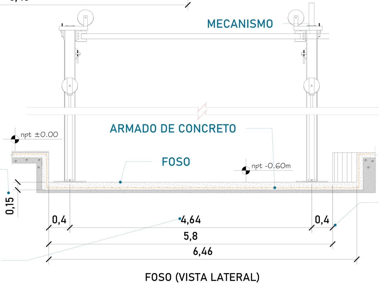
Firme de concreto con una resistencia de  $f'c=250\text{kg/cm}^2$
