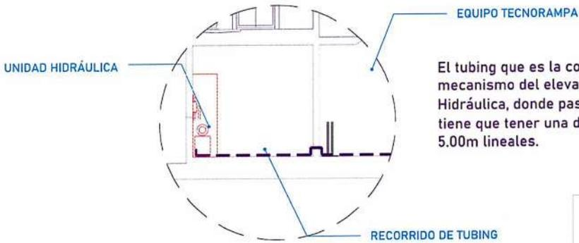
El tubing que es la conexión del mecanismo del elevador a la Unidad Hidráulica, donde pasa el aceite. No tiene que tener una distancia máxima de 5.00m lineales.
