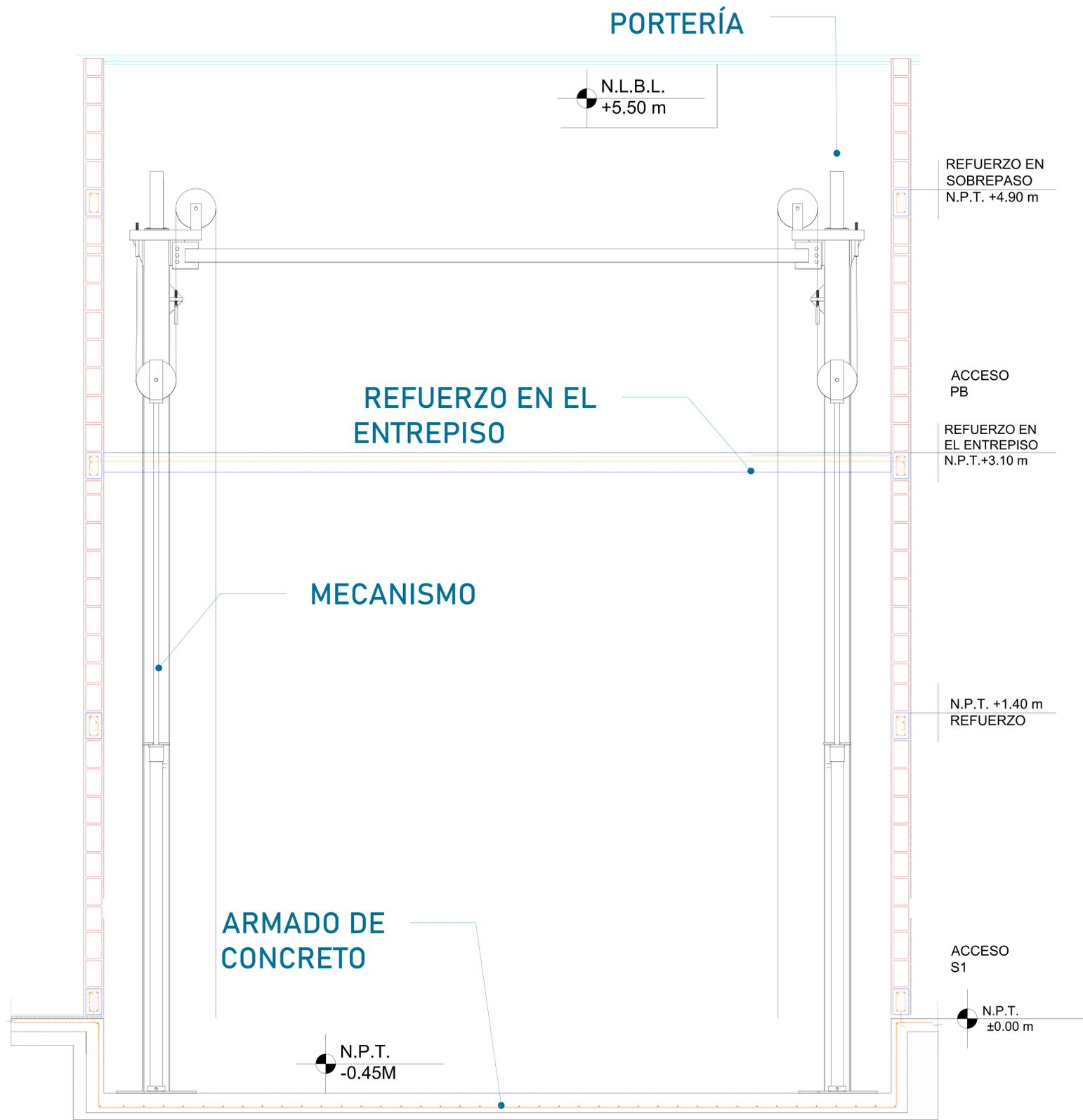
Para la estabilidad del equipo Tecnorampa debiera ser anclado a un cierto numero de refuerzos estos serán de acuerdo al recorrido del equipo y a los distintos niveles que se tengan. Para anclar se solicita una cadena de concreto ( $f'c=250 \text{ kg/cm}^2$ ) o una viga de acero, ambas minimo de 15 cm. En la ultima estación nuestras columnas tienen un sobrepaso de 1.80m por lo tanto se solicita un refuerzo a esa altura.
