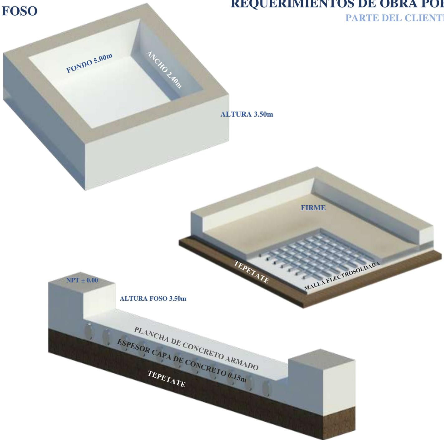
Se recomienda el uso de concreto con una resistencia mínima de  $f'c=250\text{kg/cm}^2$  armado con malla electro soldada 6.6 10.10 delgada después de los primeros 10cm para el mejor anclaje del equipo, a lo largo y ancho del área de instalación
