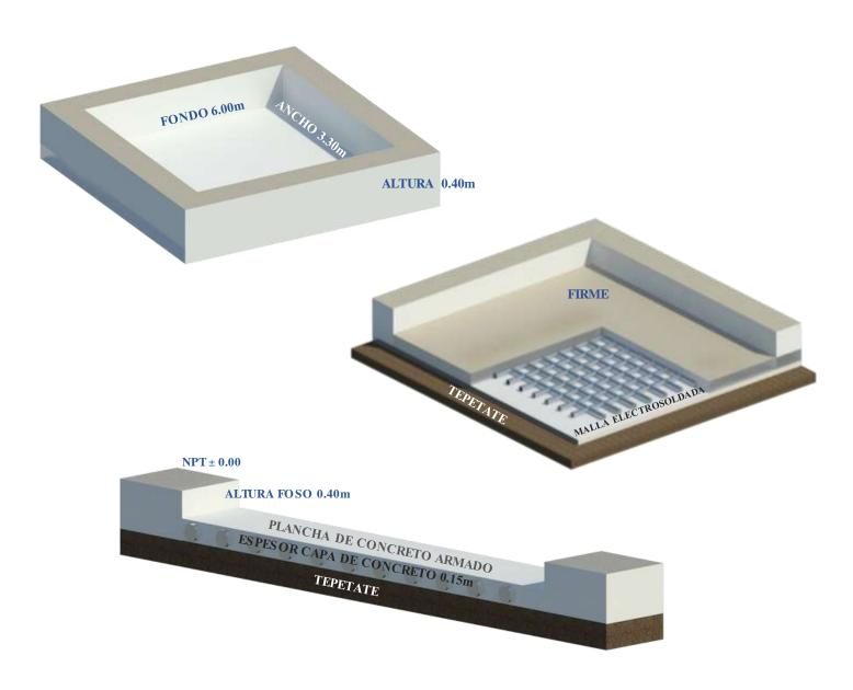
Se recomienda el uso de concreto con una resistencia mínima de f´c=250kg/cm² armado con malla electro soldada 6.6 10.10 delgada después de los primeros 10cm para el mejor anclaje del equipo, a lo largo y ancho del área de instalación
