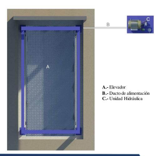
**NOTA:** La distancia B se cubrirá de ser posible con ductos realizados con tubería, y la salida en el foso será recomendable ubicarla del lado donde se encontraran las columnas y el resto de la estructura del elevador. En caso de que no se pueda instalar estos ductos se empleara una canalización diferente que proteja el cableado. En cualquiera de los dos casos esta será suministrada por parte de Tecno Rampa, y los trabajos para su instalación lo hará el equipo de la empresa.
