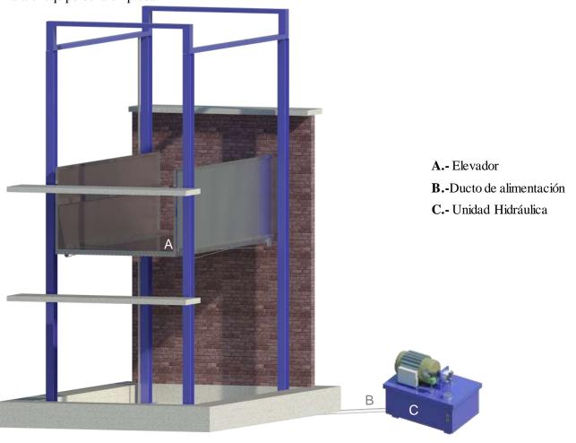
La unidad hidráulica y control eléctrico deberán ser instalados fuera del foso y ubicarse en un lugar libre de polvo, líquidos e inclemencias del clima, evitando que se contamine el aceite y se pierda la garantía del equipo.
