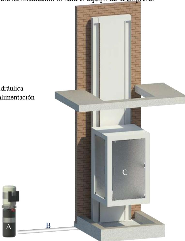
La unidad hidráulica y control eléctrico deberán ser instalados fuera del foso y ubicarse en un lugar libre de polvo, líquidos e inclemencias del clima, evitando que se contamine el aceite y se pierda la garantía del equipo.
