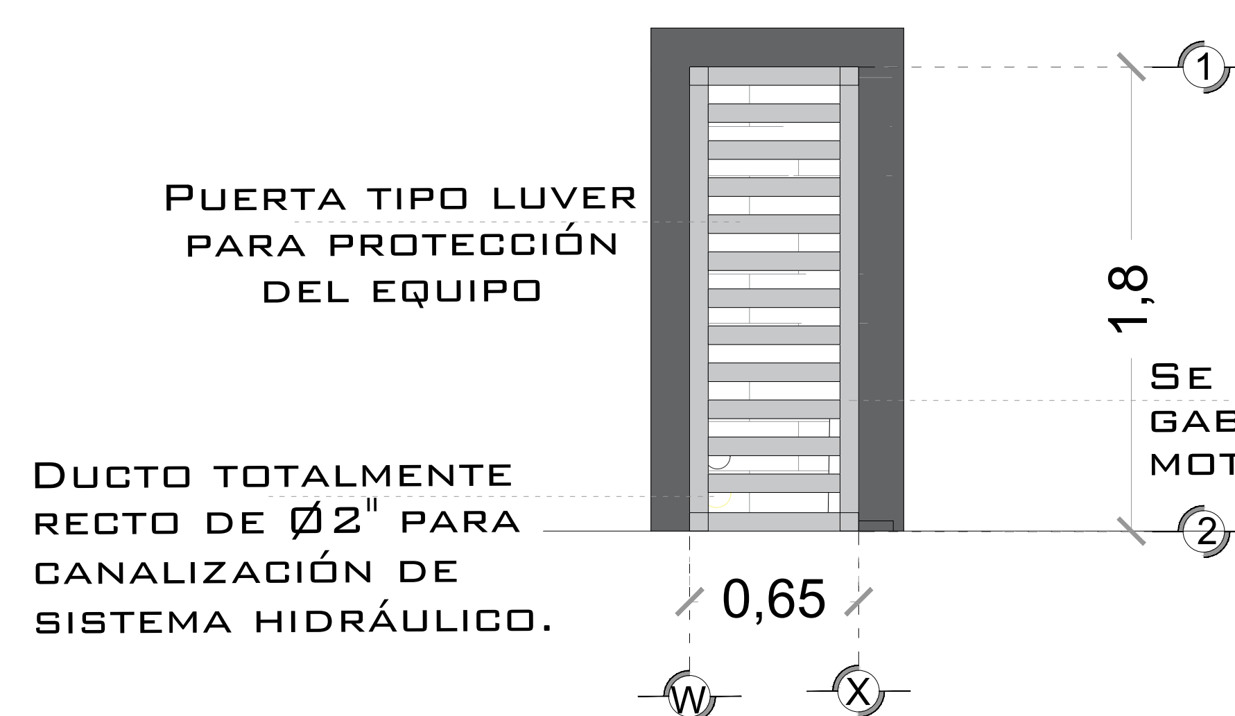
DESCRIPCION DE UNIDAD HIDRAULICA GABINETE (VISTA FRONTAL)
