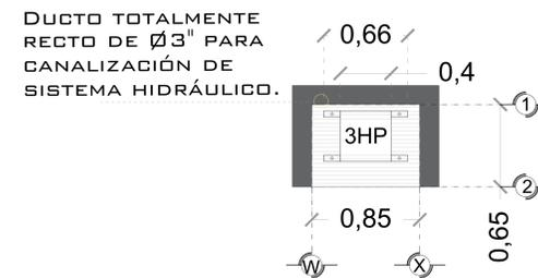
LA DISTANCIA "B" SE CUBRIRÁ DE SER POSIBLE CON DUCTOS REALIZADOS CON TUBERÍA Y LA SALIDA EN EL FOSO SERÁ RECOMENDABLE UBICARLA DEL LADO DONDE SE ENCONTRARAN LAS COLUMNAS Y EL RESTO DE LA ESTRUCTURA DEL ELEVADOR. EN CASO DE QUE NO SE PUEDA INSTALAR ESTOS DUCTOS SE EMPLEARA UNA CANALIZACIÓN DIFERENTE QUE PROTEJA EL CABLEADO. EN CUALQUIERA DE LOS DOS CASOS ESTÁ SERÁ SUMINISTRADA POR PARTE DE TECNORAMPA Y LOS TRABAJOS PARA SU INSTALACIÓN LO HARÁ EL EQUIPO DE LA EMPRESA.
