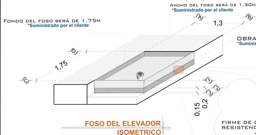
OBRA CIVIL PARA EL ANCLAJE DEL EQUIPO
