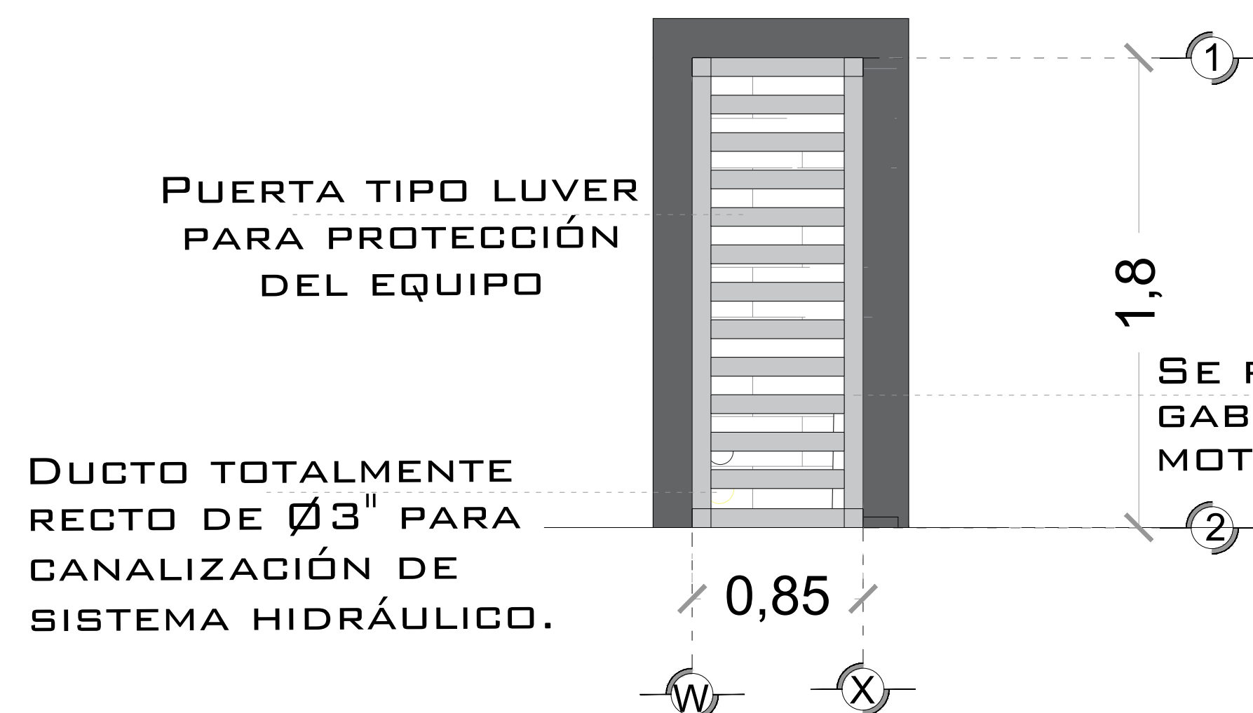
DESCRIPCION DE UNIDAD HIDRAULICA GABINETE (VISTA FRONTAL)
