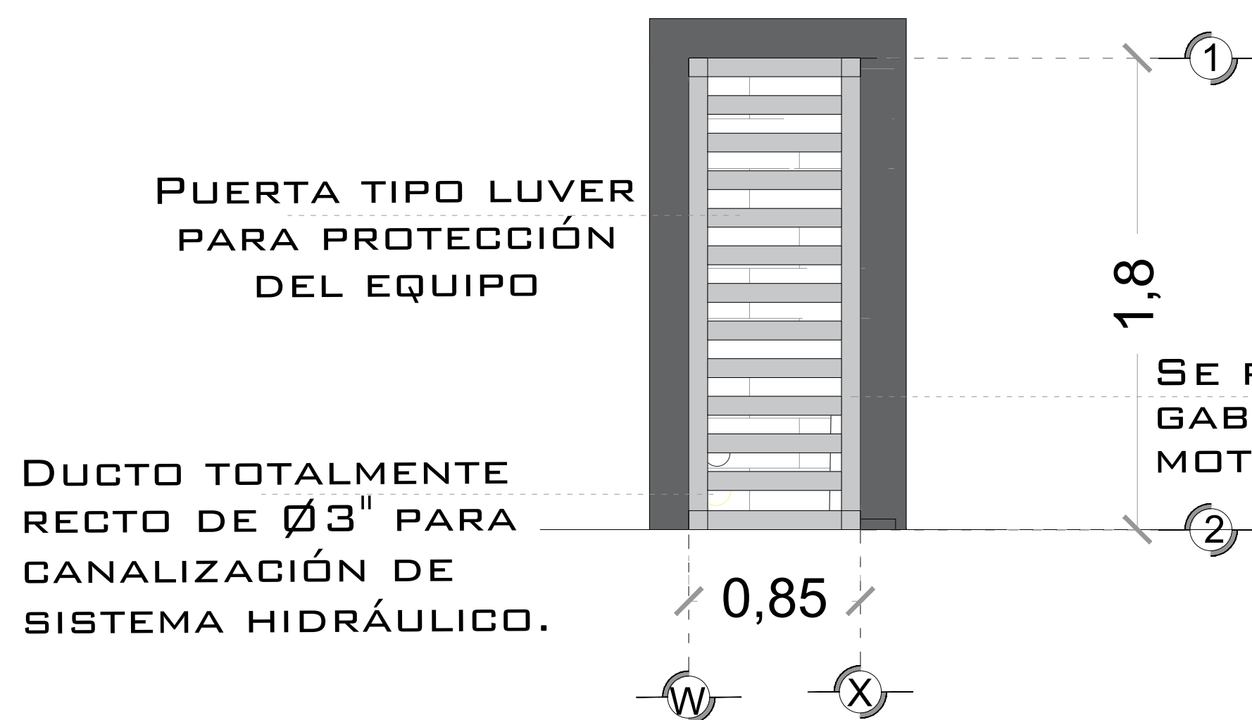
DESCRIPCION DE UNIDAD HIDRAULICA GABINETE (VISTA FRONTAL)
