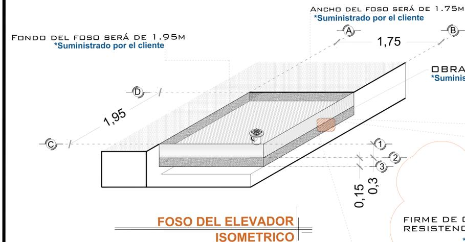
OBRA CIVIL PARA EL ANCLAJE DEL EQUIPO
