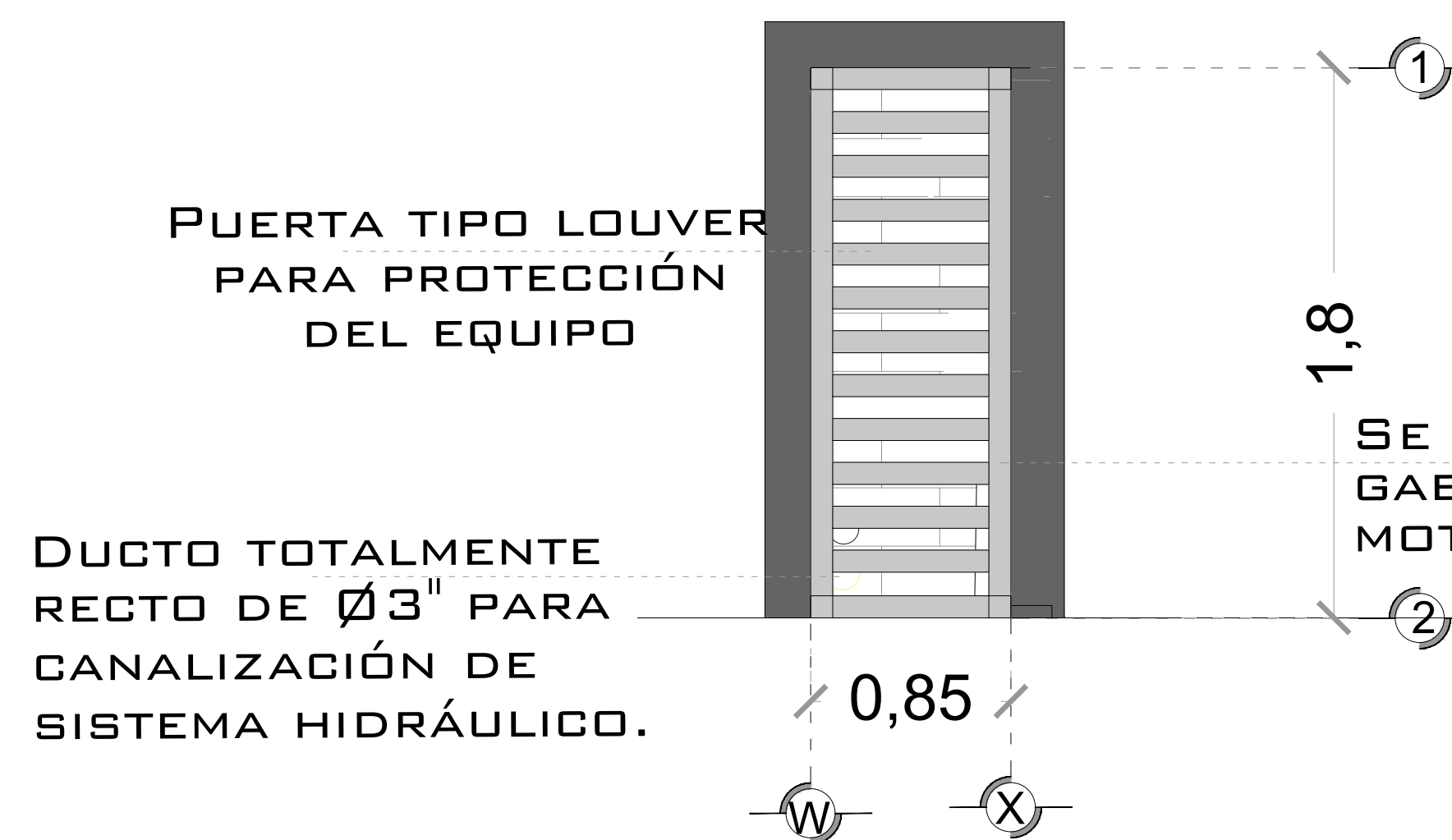
DESCRIPCION DE UNIDAD HIDRAULICA GABINETE (VISTA FRONTAL)
