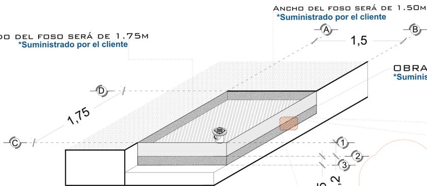
OBRA CIVIL PARA EL ANCLAJE DEL EQUIPO
