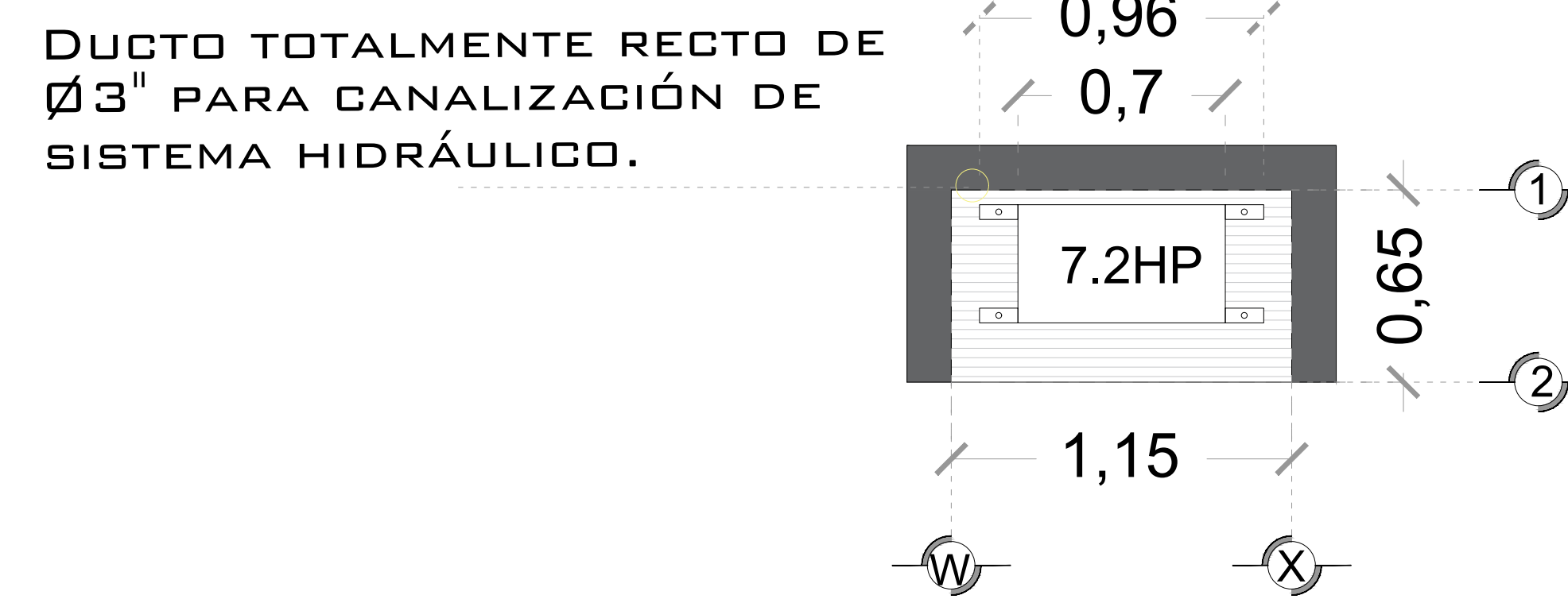
DESCRIPCION DE UNIDAD HIDRAULICA GABINETE (VISTA PLANTA)
